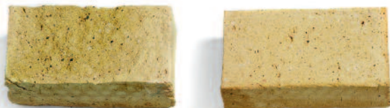
Kulbrændt mursten fra Petersen Tegl. Stenens poreopbygning er optimal og der opstår ingen frostsprængninger. Knækket sten | Skåret sten
