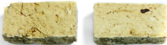
Mursten fra Nørholm Vandmølle. Med sin optimale poreopbygning har stenen været upåvirket af frostskafer gennem mere end 200 år Knækket sten | Skåret sten
