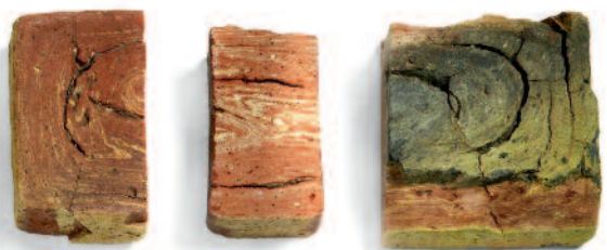
Sten produceret på sneglepresse. Leret er lagdelt, og der er opstået frostskafer.
